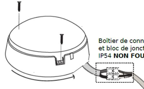
Boîtier de connexion et bloc de jonction IP54 NON FOURNIS
