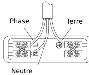
La section des câbles ne doit pas être inférieure à 2.5mm<sup>2</sup>
